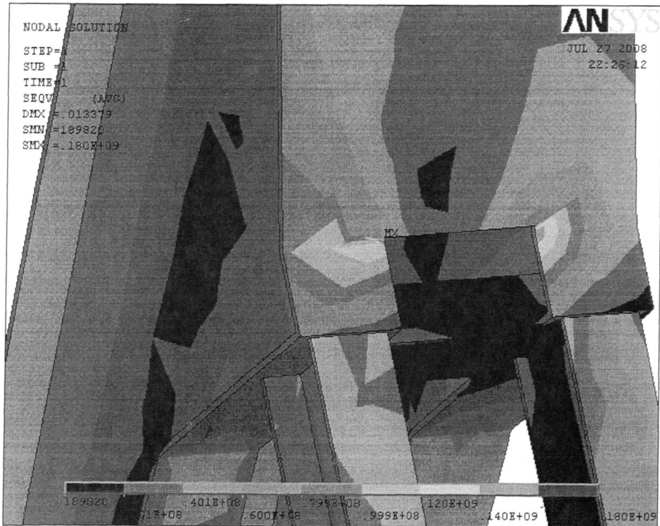
图 5-16 人字架最大应力放大图
