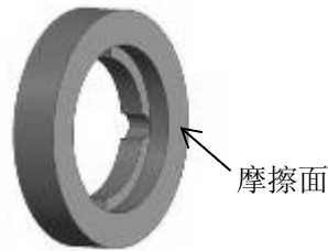
图 2-7 摩擦环示意图
