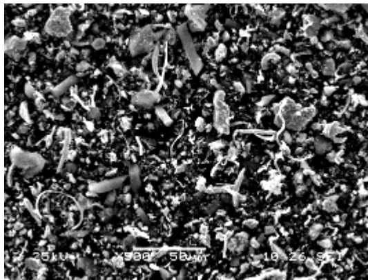
图 3-4 3-3 号试样磨屑的 SEM 照片
