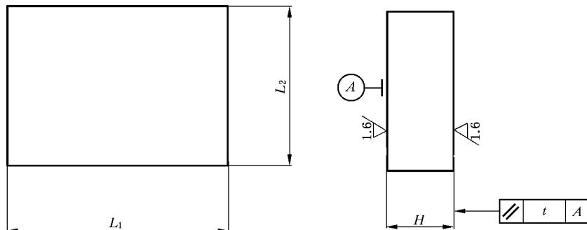
未注表面粗糙度  $R_a = 6.3 \mu\text{m}$ ; 全部棱边倒角  $2 \text{ mm} \times 45^\circ$ 。
