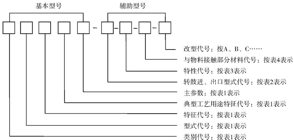
4.4 分离机的基本型号由基本代号与主参数两部分组成。基本型号用名称中有代表性的大写汉语拼音字母表示,主参数用阿拉伯数字表示,并应符合表1的规定。
