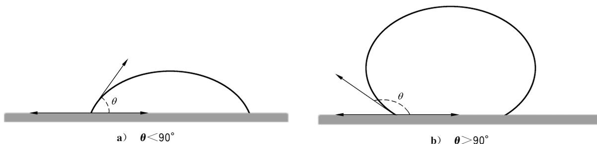
图1 静态接触角示意图
