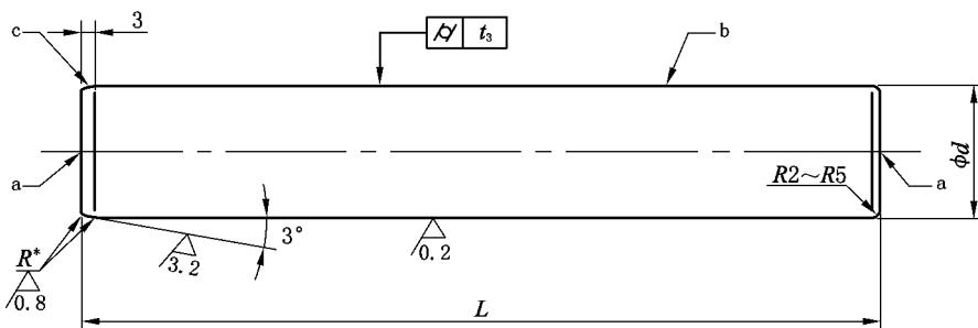
未注表面粗糙度  $R_a 6.3 \mu\text{m}$ 。
