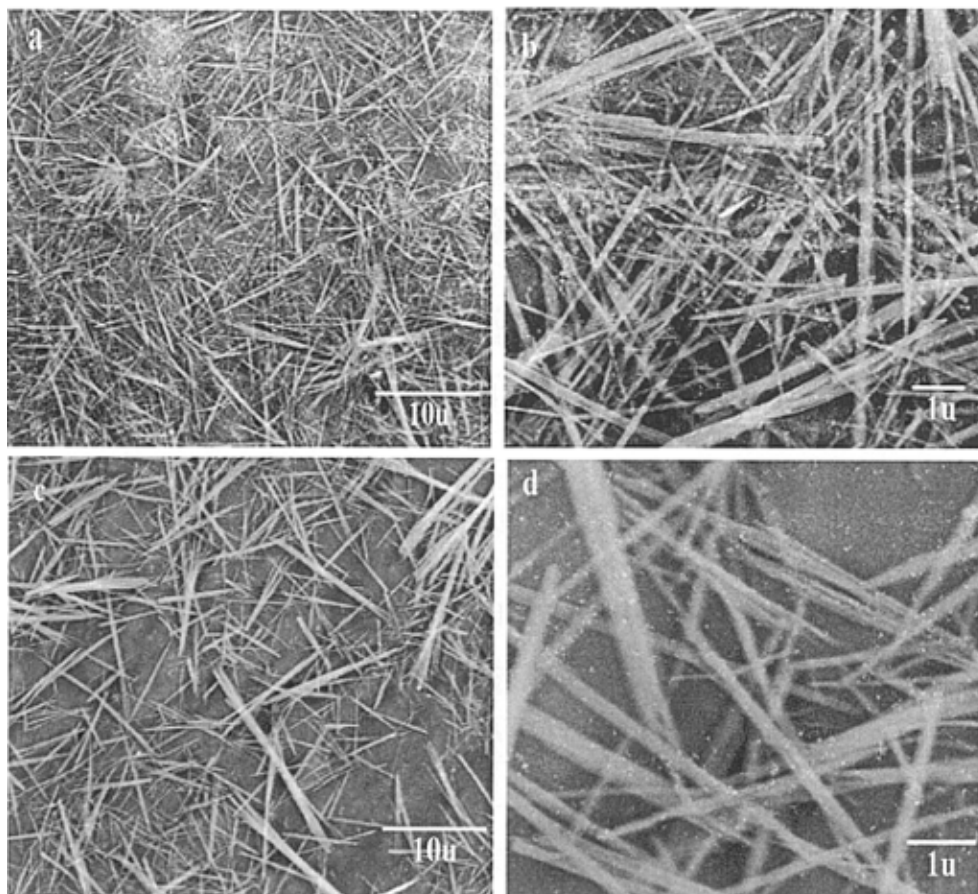
图 3-2 \text{Ce}(\text{H}_2\text{PO}_2)_3 \cdot \text{H}_2\text{O} 纳米棒的扫描电镜图
