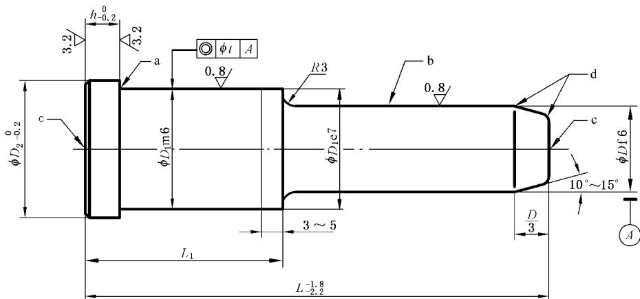
未注表面粗糙度  $R_a = 6.3 \mu\text{m}$ ；未注倒角  $1 \text{ mm} \times 45^\circ$ 。
