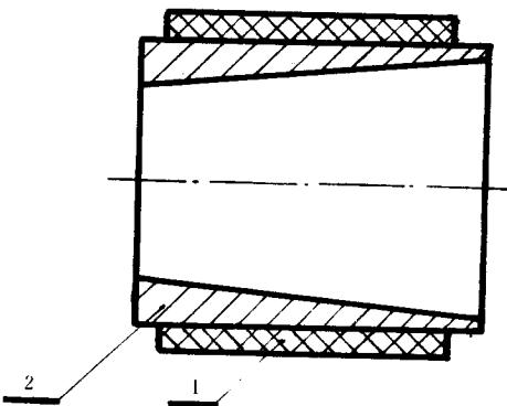
图1 塑料轴承和钢轴套
