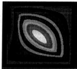
图 5-24  $N=150$  时衍射光栅表面相位浮雕图样
