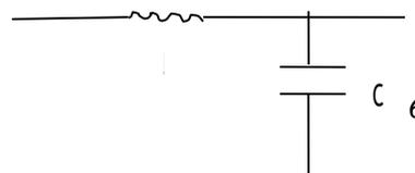
图 2-4LC 低通滤波器
