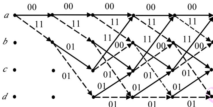
**习题 10.17** 已知一个 (2, 1, 2) 卷积码编码器输出和输入的关系为
