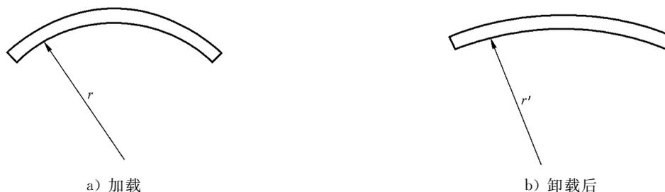
图1 试样加载和卸载后的曲率半径
