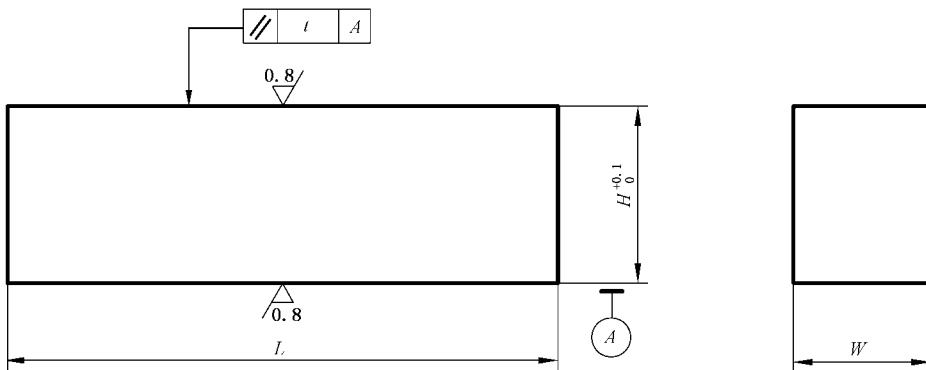
未注表面粗糙度  $R_a=6.3 \mu\text{m}$ ；全部棱边倒角  $2 \text{ mm} \times 45^\circ$ 。
