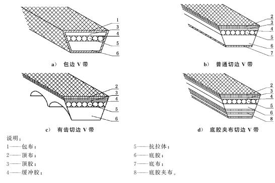
图 1 V 带结构示意图
