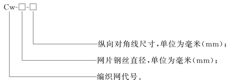
示例:网片钢丝直径3.5 mm,纵向间距160 mm的编织网代号为:Cw-3.5-160。
