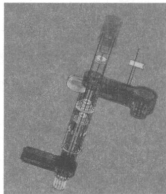
图 6 第二、第三关节装配爆炸图
