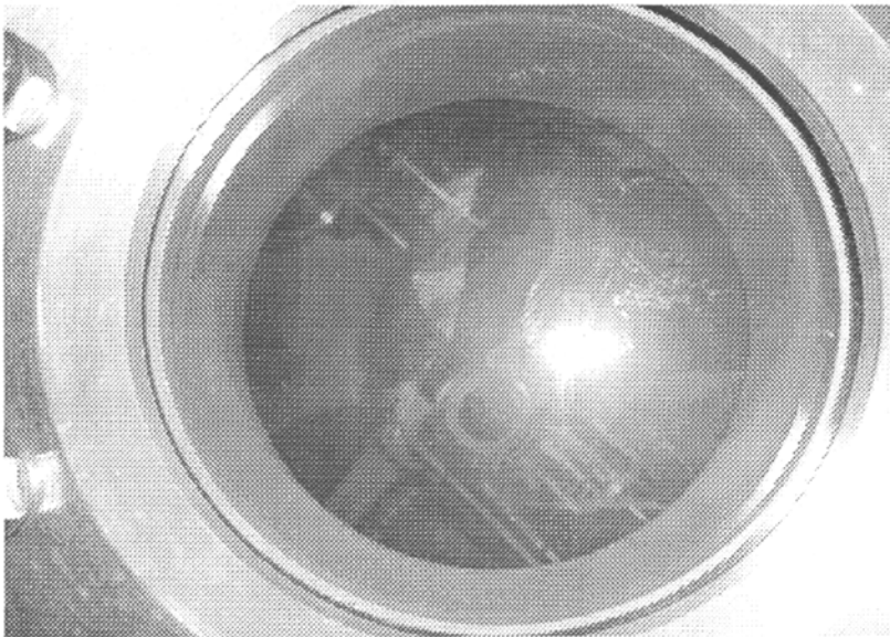
图 2-7 正在进行薄膜沉积的真空工作室
