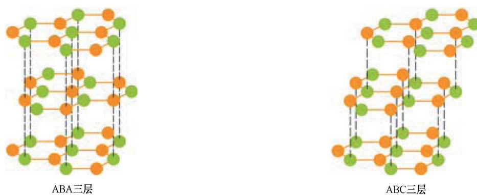
d) Bernal 堆垛(AB 堆垛) (3.4.1.10) 三层石墨烯 (3.1.2.9) 和 rhombohedral 堆垛(ABC 堆垛) (3.4.1.11) 三层石墨烯 (3.1.2.9)
