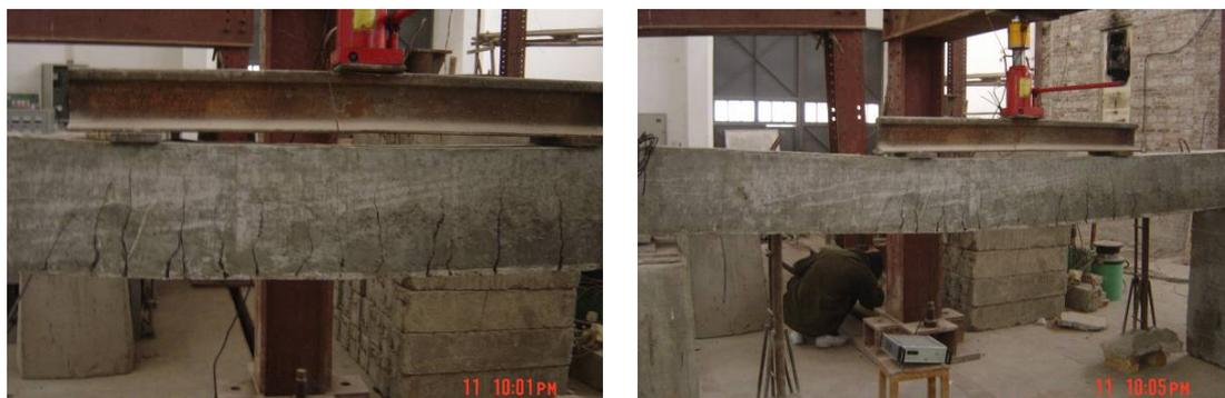
图 4-6 裂缝分布图
