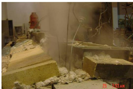
图 4-10 预留孔洞处喷出水蒸气照片
