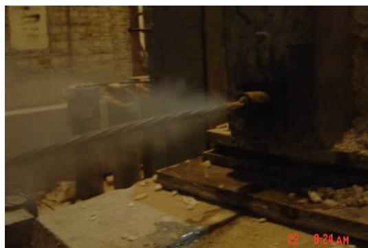
图 4-11 端部锚具处喷出水蒸气照片
