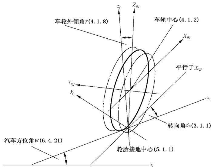
车轮固结坐标系( $X_w, Y_w, Z_w$ )的单位矢量( $i_w, j_w, k_w$ )和地面固定坐标系( $X, Y, Z$ )单位矢量( $i^*, j^*, k^*$ )的关系:
