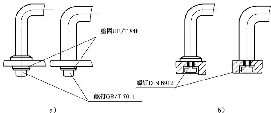
注：螺钉 DIN 6912 是一种带扳手导孔的内六角低圆柱头螺钉。
