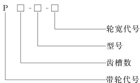
示例: 齿槽数 30, 型号 AT20, 轮宽代号 50 的带轮标记为: P30-AT20-50
